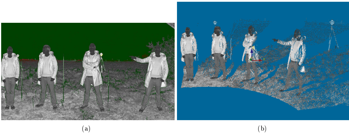
Abbildung 2.8: Ausschnitt aus einem Intensitätsbild eines 3D Panorama Scans (a), Ausschnitt aus einer Punktwolke (b)
