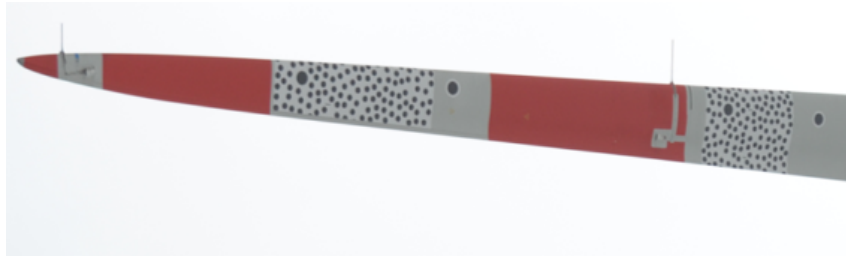
Abbildung 2.17: Punktmuster auf einem Rotorblatt. Eine erfassung der Rotorblattdeformationen an den signalisierten stellen erfolgte in Winstroth u. a. (2014)
