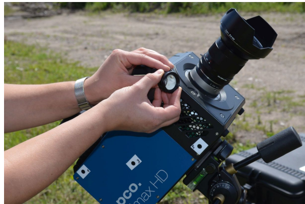
Abbildung 5.23: Bestimmung der Position der Kamera, die Punktmarken sind im Koordinatensystem der Kamera bekannt. Die Messung der Strecke erfolgt mit einem Prisma.
