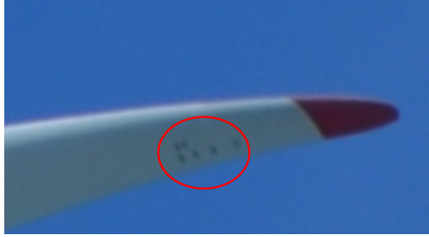
Abbildung 3.6: Markante Punkte durch Verschmutzung auf einem Rotorblatt
