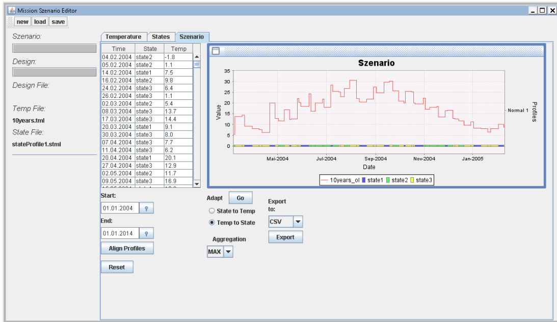
Abbildung B.9: Missionsszenario-Editor: Erstellung des Szenarios. Hierbei wird der Temperaturverlauf aus Abbildung B.7 mit den Zuständen des Systems zusammengeführt. Das Ergebnis ist das Missionsszenario.
