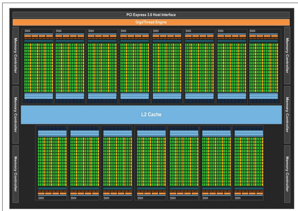
Abbildung C.1: NVIDIA Kepler GK110 Grafik Prozessor (GPU): Zu sehen sind die 15 Streaming Multiprozessoren(SMX, Compute Units), die jeweils aus 192 Single Precision Units (grün) und 64 Double Precision Units (gelb) bestehen. Insgesamt sind es 2880 Single Precision Units und 960 Double Precision Units die auf eine Rechenleistung von 5.1 TFlops Single Precision und 1.7 TFlops Double Precision kommen. Quelle: [Whitepaper - NVIDIA's Next Generation CUDA Compute Architecture: Kepler GK110]
