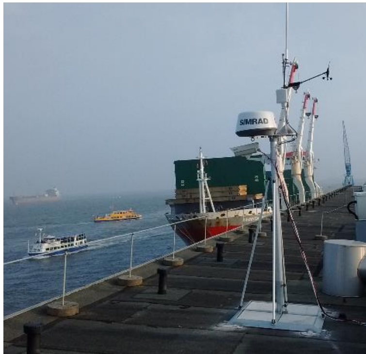
Abbildung 1.1: Station eines maritimen Beobachtungssystems mit optischen Sensoren, Windsensor, AIS-Empfänger (Automatic Identification System) und Radar für die Erprobung und Demonstration von e-Navigations-Diensten an einer Wasserstraße (Cuxhaven, Deutschland)
