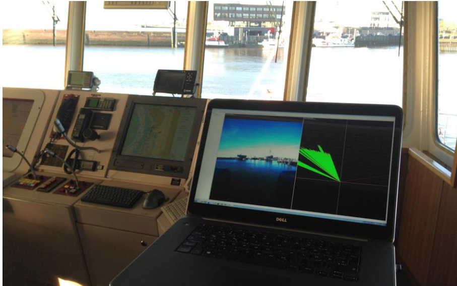
Abbildung 6.2: Livepräsentation von funkübertragenen Datenströmen auf der Brücke des Forschungsschiffs Heincke. Visuelle Kamera auf der linken Bildschirmseite, LIDAR-Scanner auf der rechten Bildschirmseite
