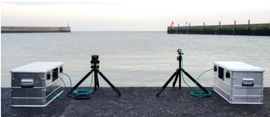
Abbildung 5.5: Mobile autonome Sensorsysteme, ausgestattet mit visueller Kamera (rechts) sowie LIDAR Scanner (links) in einem Hafengebiet, bieten Energieversorgung, Schnittstellen und Kommunikation für dezentrale Beobachtungen maritimer Studiengebiete
