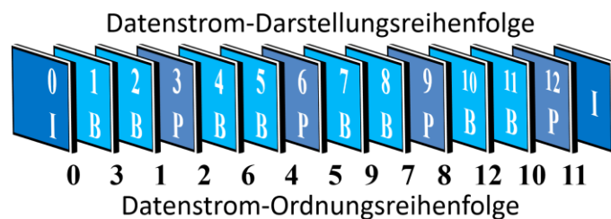
Abbildung 5.20: Bildgruppe (Group of Pictures, GOP) für eine H.264 / MPEG-4 Komprimierung eines Videodatenstroms, Beispiel für: Intra-Coded Picture (I-Frame), Bidirectionally Predictive-Coded Picture (B-Frame, zwischenberechnet und stark komprimiert), Predictive-Coded Picture (P-Frame gering komprimiert). Datenstromdarstellungs- / Übertragungsreihenfolge, erfordern jeweils einen virtuellen Puffer bei der Codierung sowie Encodierung des Videodatenstromes
