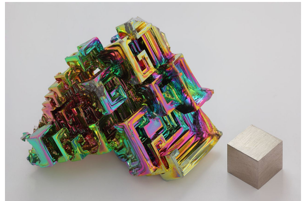
(d) Dieser Wismutkristall ist von einer dünnen Oxidschicht bedeckt. Je nach Dicke entstehen durch Interferenz verschiedene Farbeindrücke. Rechts unten im Bild ist ein noch nicht oxidiertes Wismutkristall zu sehen.
