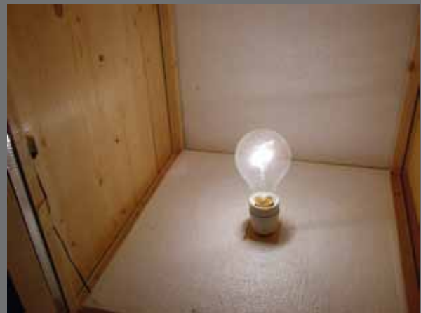
Benno Baumann: Wärmedurchlässigkeitsmessung mittels Wärmelampe.
