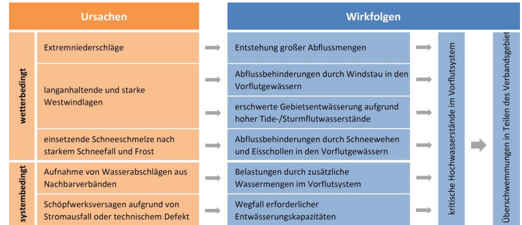
Grafik 35: Potenzielle wetter- und systembedingte Ursachen und Wirkfolgen hinsichtlich der Entstehung kritischer Hochwasserstände und möglicher Überschwemmungssituationen im Gebiet des I.EVE
