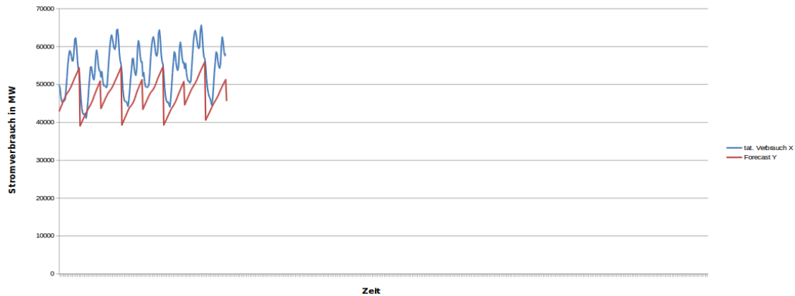
Abbildung 124: Vergleich von tatsächlichen und vorhergesagten Stromverbrauch. Versuch: „Spl-Wende“
